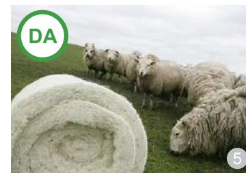
Saltele termoizolante din lână de oaie
