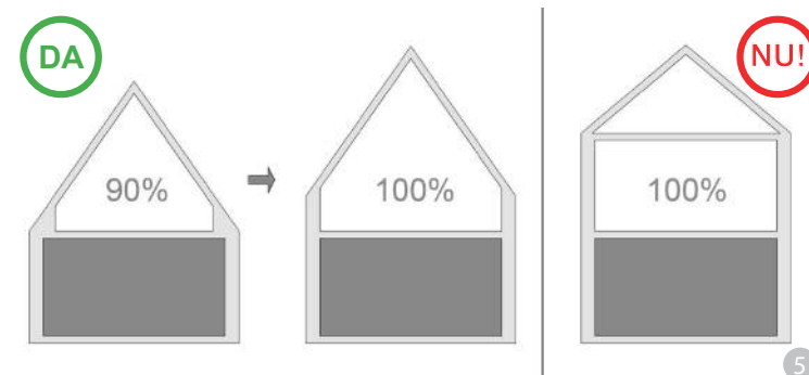
Șchița reflectă modul în care mansardarea podurilor reprezintă un câștig de suprafață locuită sensibil egală cu cea din varianta construirii unui nou etaj. Construirea unei clădiri înalte pune serioase probleme de încadrare în specificul local.
